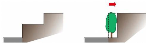
法面や擁壁の長大化は避け、分節化
