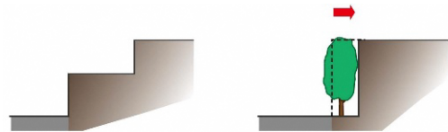
法面や擁壁の長大化は避け、分節化
