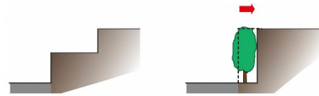
法面や擁壁の長大化は避け、分節化
