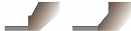
なだらかな法面と擁壁の組み合わせ等で圧迫感を軽減する
