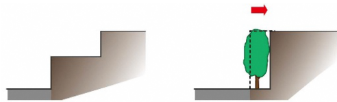
法面や擁壁の長大化は避け、分節化
